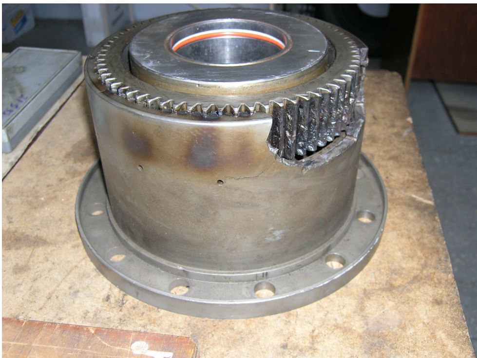
Рисунок 10 – Разрушение зубчатой муфты компрессора синтез газа 103J
