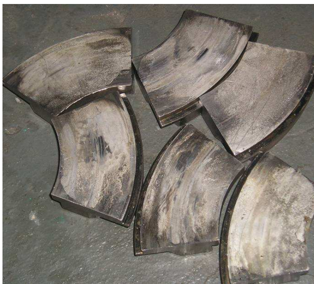
Рисунок 3 – Износ упорных колодок штатного опорно-упорного подшипника турбины ТК синтез-газа 103JT
