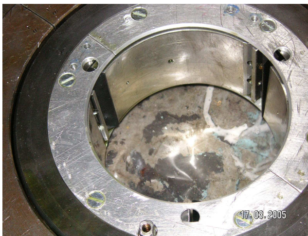
Рисунок 2 – Общий вид подшипника ПД120 турбины 103JT
